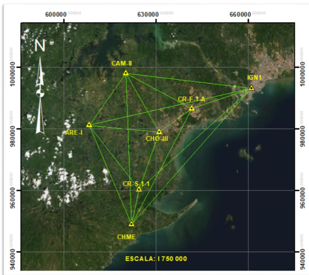
Fig. No 7. Red geodésica propuesta para la provincia de Panamá Oeste. La misma consta de 7 vértices o PC y su geometría es de una red de triángulos equiláteros.
