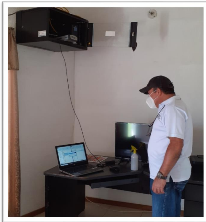
Fig. No 26. Etapa en la que el compañero Javier Cornejo, del Departamento de Geodesia y Astronomía del Instituto Geográfico Nacional "Tommy Guardia", procede a descargar los datos almacenados en el receptor Trimble Net R9. El mismo está ubicado en el aeropuerto de Chame.
