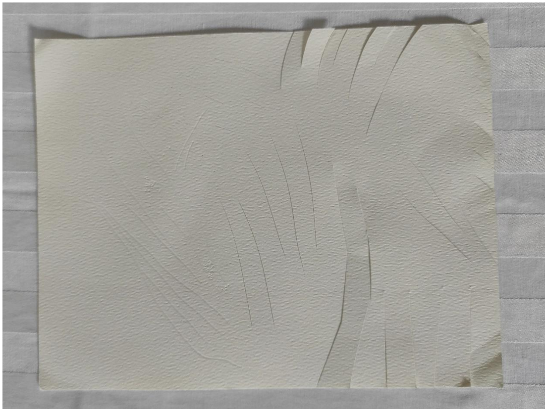
Ilustración 65. Resultados de prueba de resistencia a las herramientas de corte en papel acuarela.
