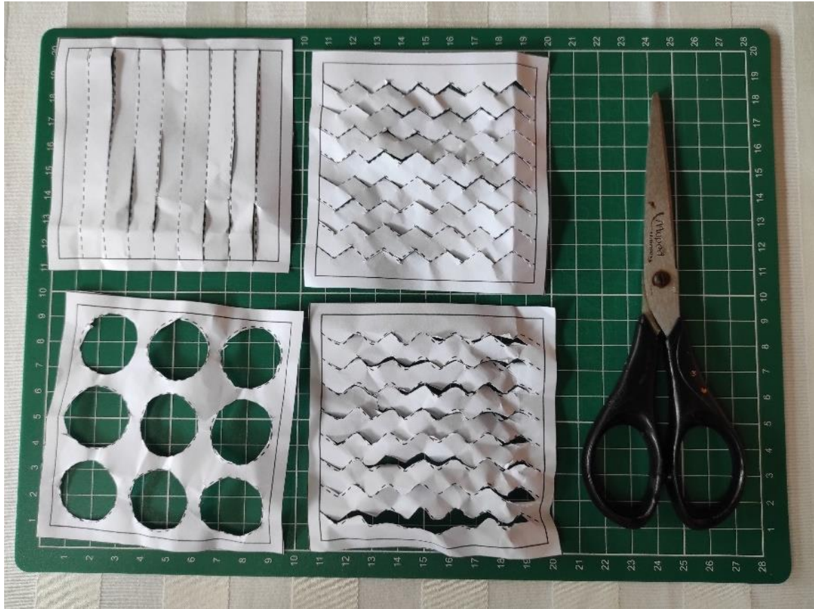
Ilustración 7. Resultados de la prueba de adaptabilidad en tijeras de oficina.
