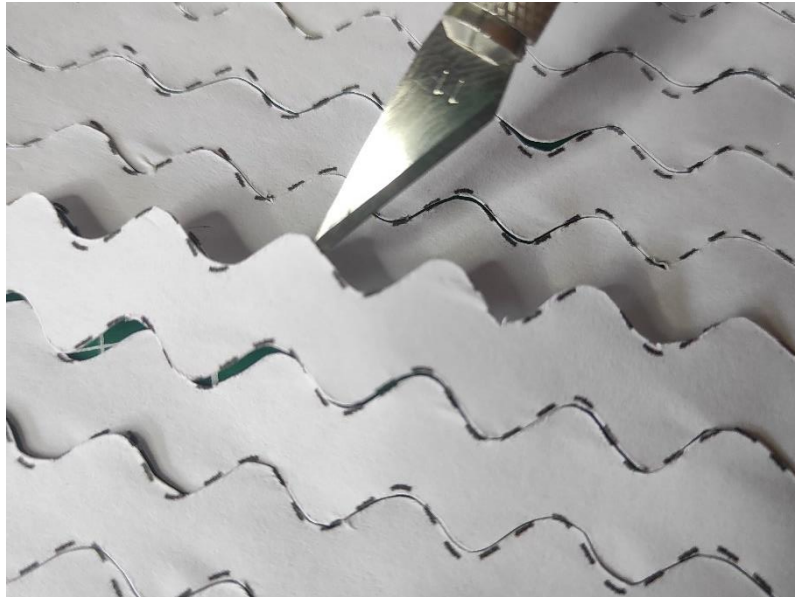
Ilustración 15. Patrón en ondas cortado por la cuchilla en punta.
