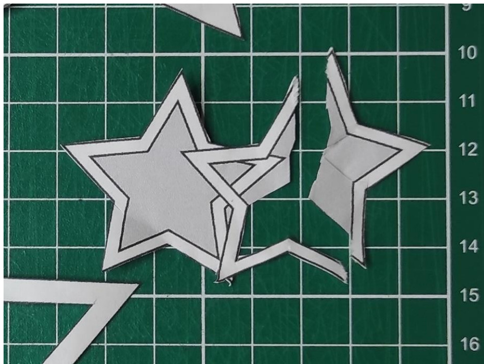
Ilustración 31. Estrella pequeña rasgada durante la prueba de versatilidad con tijeras textiles.
