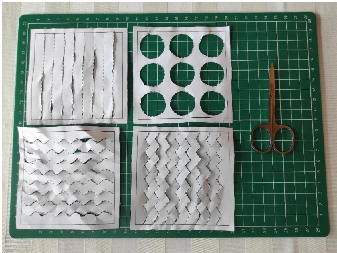
Ilustración 13. Resultados de la prueba de adaptabilidad en tijeras de manicura.
