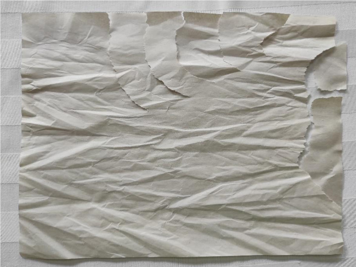
Ilustración 55. Resultados de prueba de resistencia al tacto en papel periódico.
