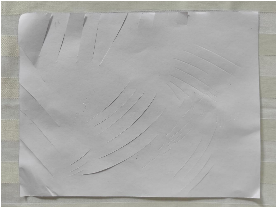
Ilustración 67. Resultados de prueba de resistencia a las herramientas de corte en cartulina.
