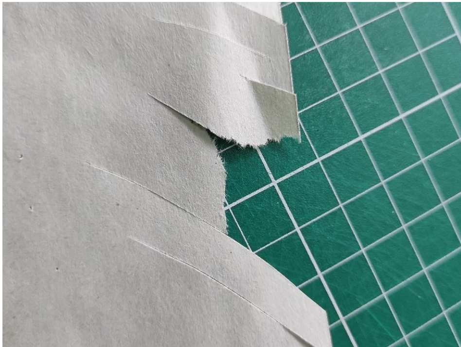
Ilustración 68. Papel periódico rasgado durante prueba de resistencia a las herramientas de corte.
