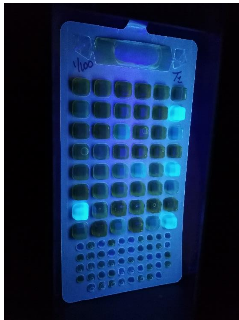
Figura 16. Bandejas Quanti-Tray para detectar E. coli en tinas de depuración.
