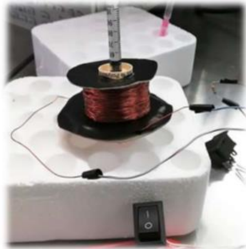
Figura 14. Muestra de cultivo de P. falciparum dentro de la jeringa desechable de 1 mL. El volumen que se utiliza para medir es de 400 uL (A) y la bobina (B) es de 585 vueltas, cuyo molde es un carrete de hilo de coser.
