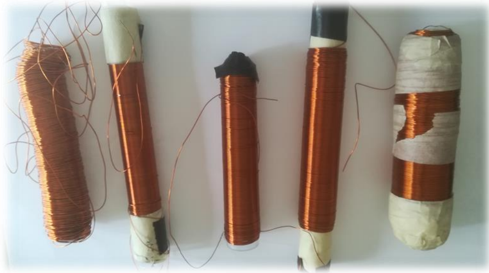
Figura 10. Primeros prototipos de bobina, desde la primera construida (izquierda a derecha).
