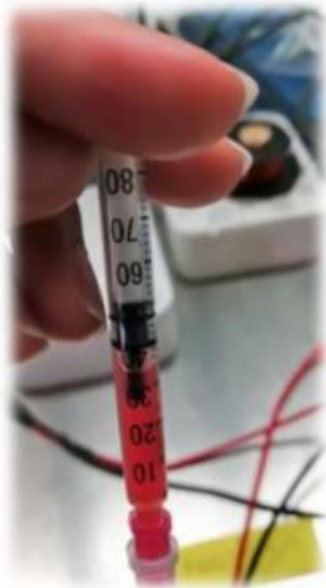
Figura 14. Muestra de cultivo de P. falciparum dentro de la jeringa desechable de 1 mL. El volumen que se utiliza para medir es de 400 uL (A) y la bobina (B) es de 585 vueltas, cuyo molde es un carrete de hilo de coser.
