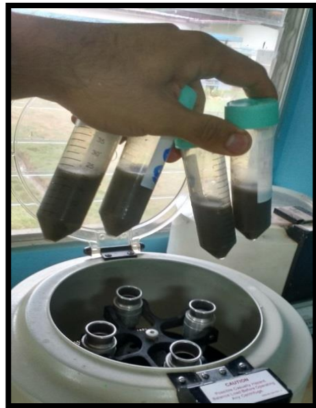
Figura 6. Colocación de tubos en la Centrífuga.
