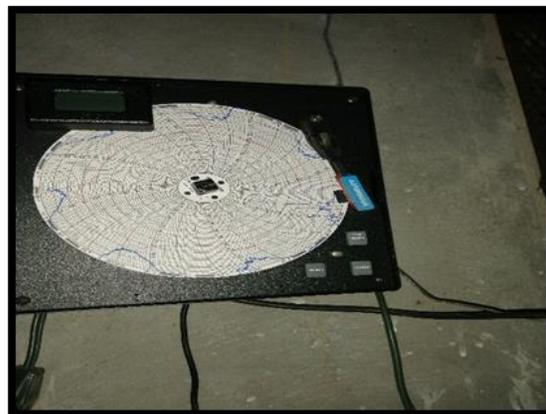
**Foto N°11. Higrómetro utilizado para el registro de la Temperatura y la Humedad Relativa en el galpón.**
