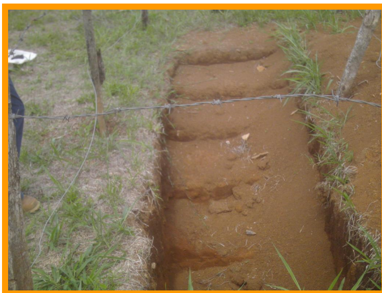
ANEXO 12. Protección de las calicatas con alambre de púas alrededor.
