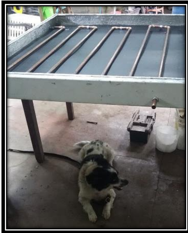
ANEXO Nº 26. Tubería intercambiadora integrada al colector
