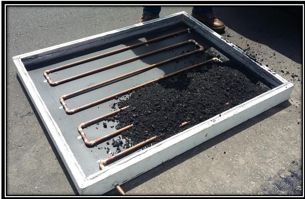
ANEXO N° 28. Colocación de la mezcla de asfalto sobre el colector
