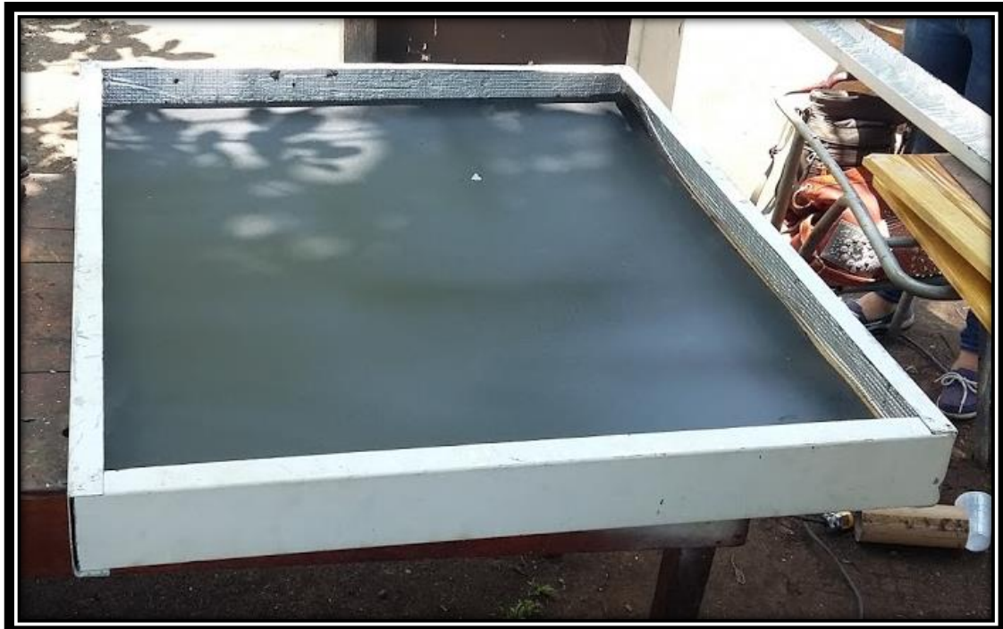
ANEXO N° 18. Barrera de calor atornillada a la madera dentro del colector
