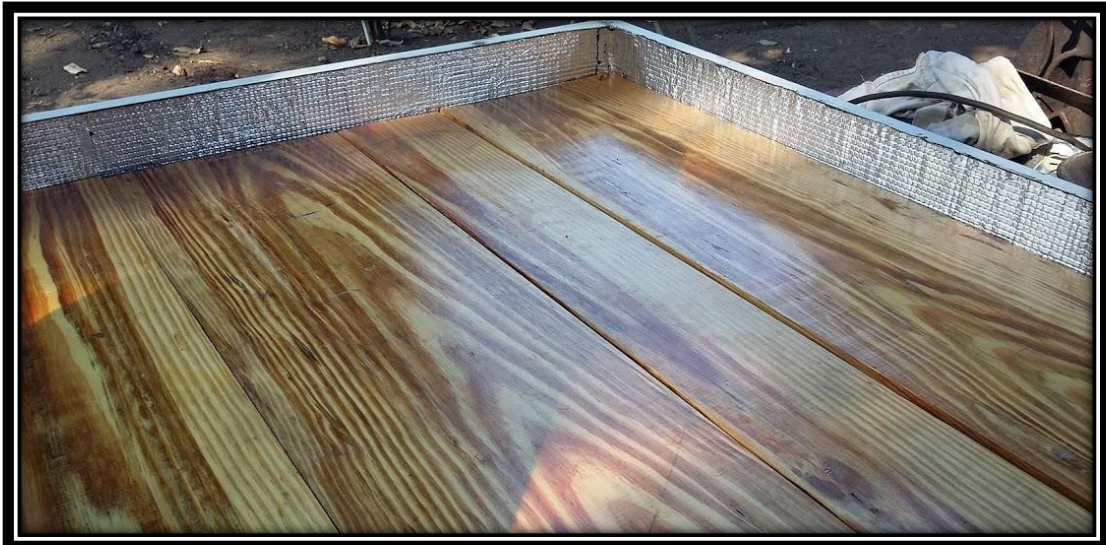
ANEXO N° 16. Marco con el fondo de madera (aislamiento)
