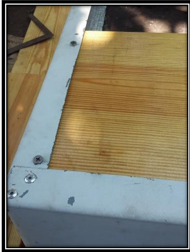
ANEXO N° 15. Sección de madera atornillada al marco
