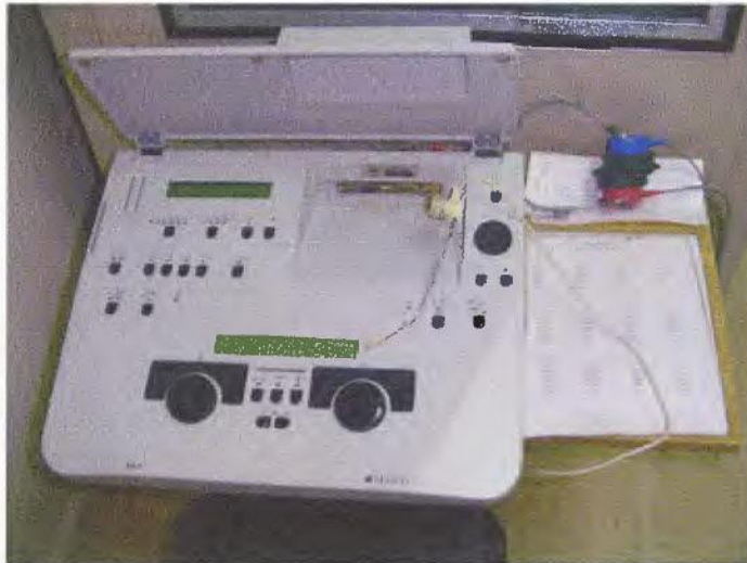
Fig. 15. Audiómetro MAICO, Modelo MAK55
