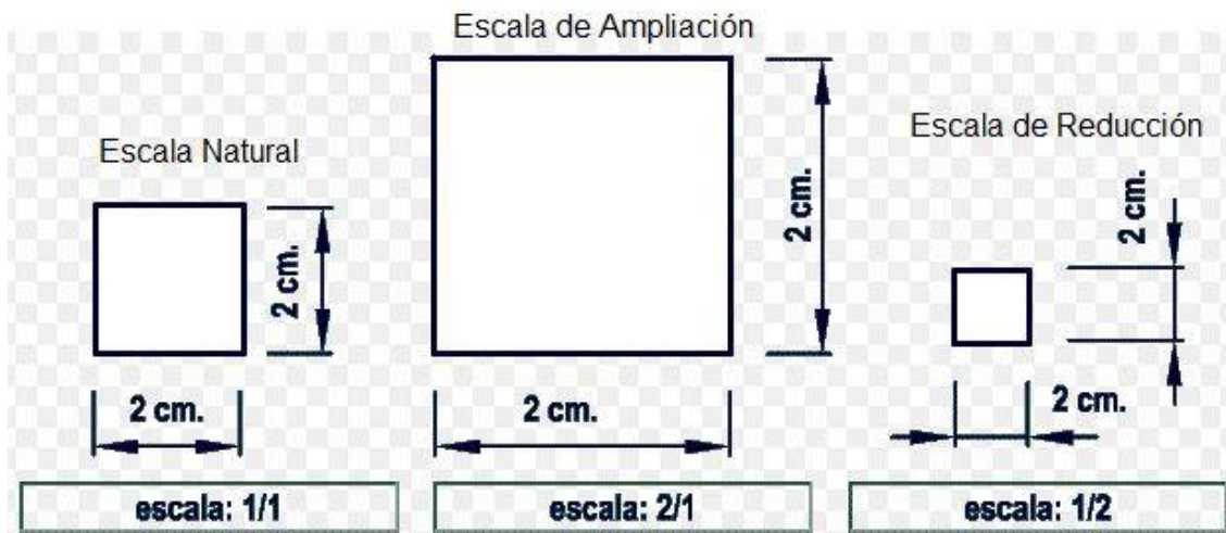
Figura 4.25. Diferentes tipos de escalas, realizada por Roberto Syala tomado del sitio web https://www.areatecnologia.com/dibujo-tecnico/escalas.html .
