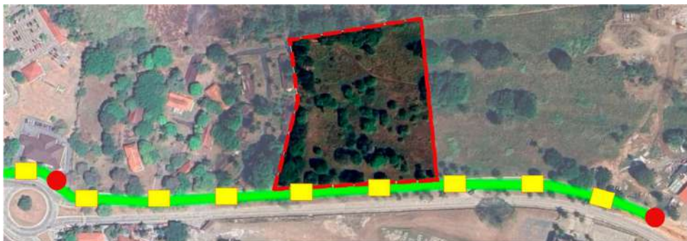
Esquema 20: Suministro de energía eléctrica al terreno
