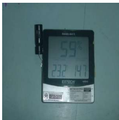
Figura 17 g. Termohigrómetro, marca Extech Instruments.
