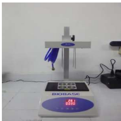
Figura 17 a. Concentrador de muestras con evaporador, marca Biobase
