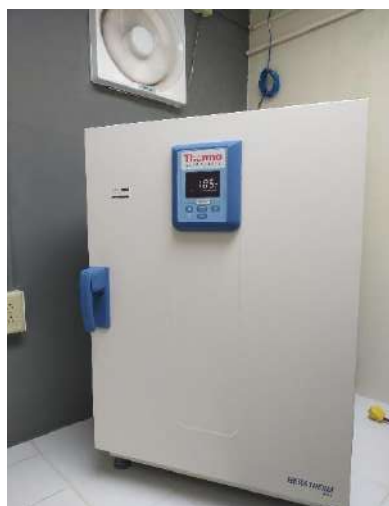
Figura 17 i. Horno de convección, marca Thermo Scientific
