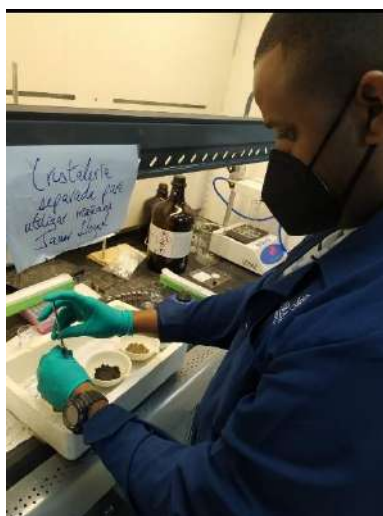
Figura 20. Fortificación de la muestra blanco para validación analítica
