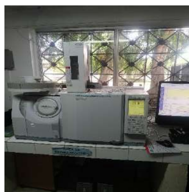
Figura 17 f. Cromatógrafo de Gases acoplado a Espectrometría de Masas, simple cuadrupolo, Marca Shimadzu, modelo GCMS-QP2010 Ultra
