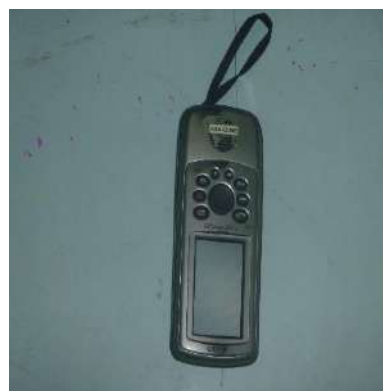
Figura 17 h. Medidor de posicionamiento geográfico (GPS), marca Garmin
