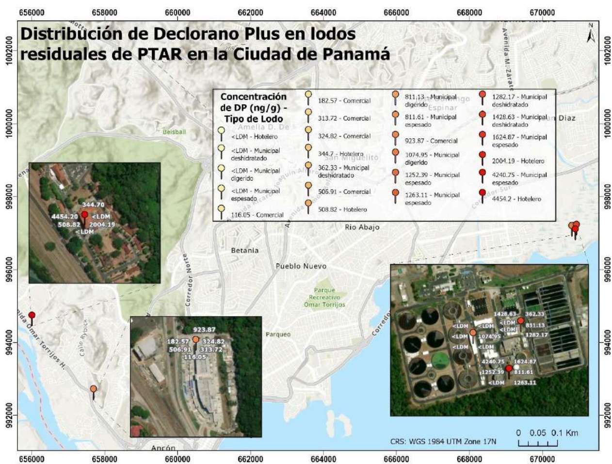
Figura 49. Distribución de DP en lodos de PTAR aplicando la herramienta de georreferenciación ARGIS.
