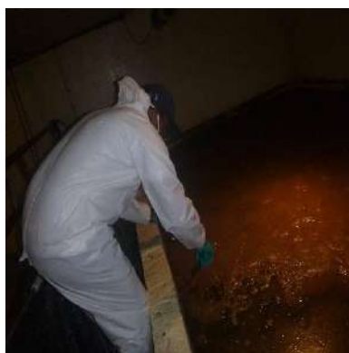
Figura 16. Colecta de muestra de lodo en Planta de Tratamiento de Agua Residual Comercial.
