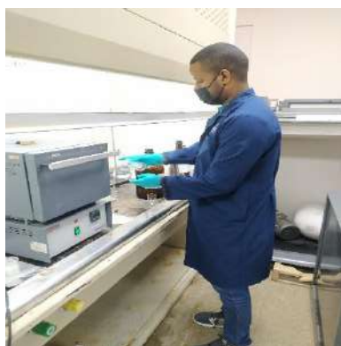
Figura 18. Acondicionamiento de los adsorbentes en la Mufla
