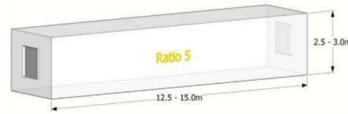
Ilustración 267. Ventilación natural cruzada.
