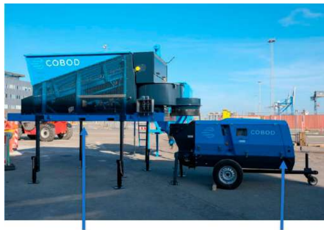
Miniplanta mezcladora de concreto
