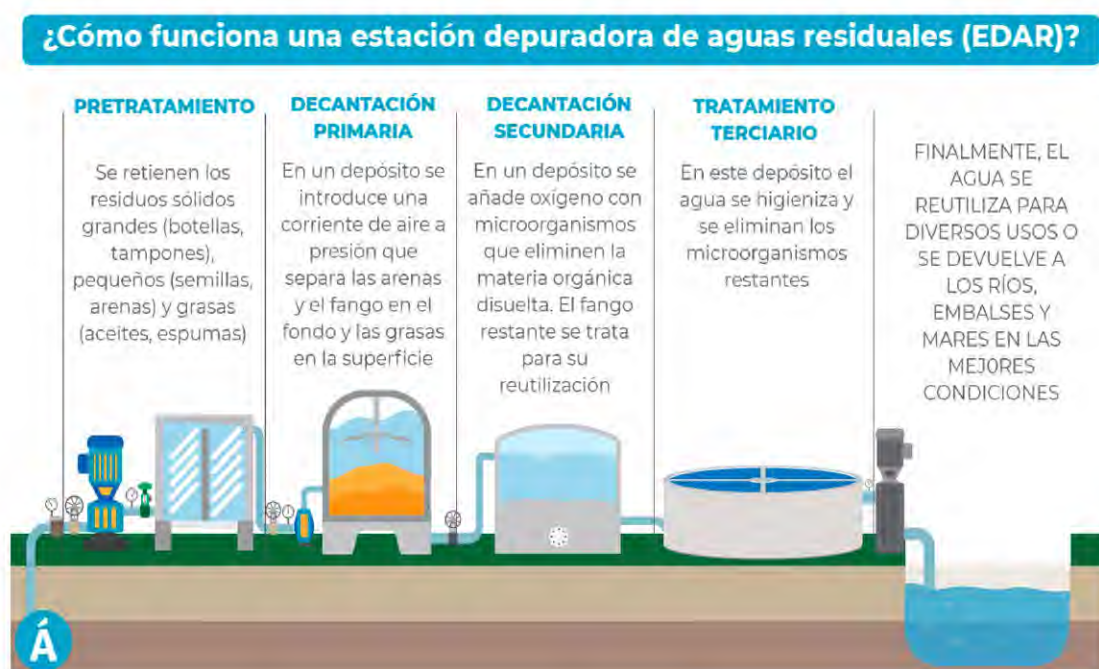
Anexo 1: Esquema del funcionamiento de una Estación Depuradora de Aguas Residuales o EDAR.
