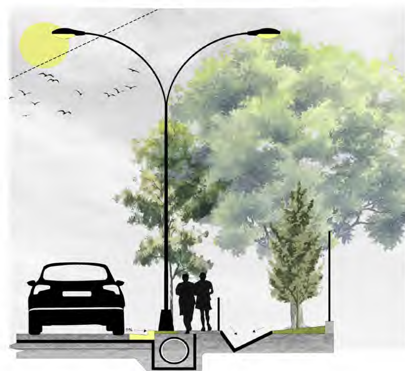
SECCIÓN 4: TIPOLOGÍA B DE ACERA EXTERIOR Escala 1:1000
