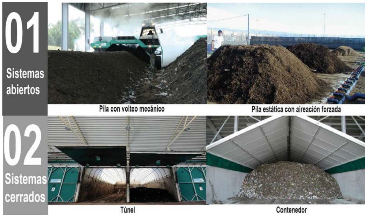
Figura 11. Fotografías de los sistemas abiertos y los sistemas cerrados
