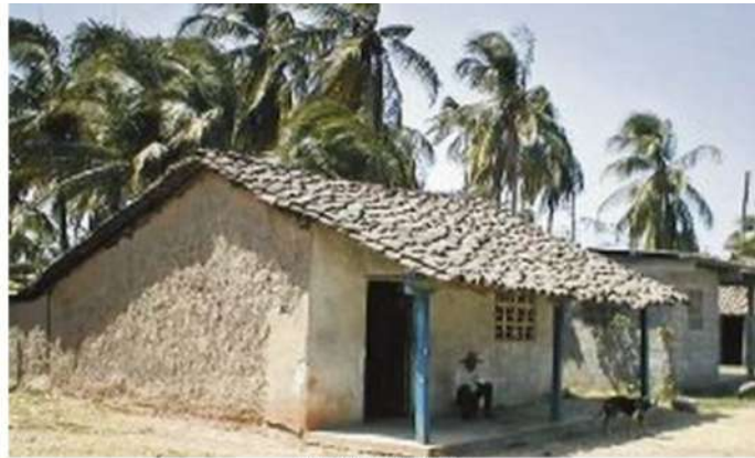
Vivienda de quincha Construcción con quincha, materiales locales mixtos como caña, fibras, madera y barro.
