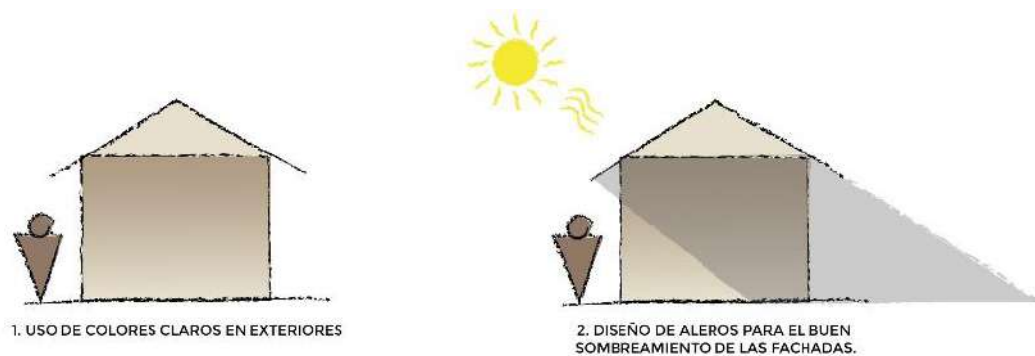
Imagen 34a: Representación gráfica de las recomendaciones de diseño para una construcción en quincha. [Realizado por autor]
