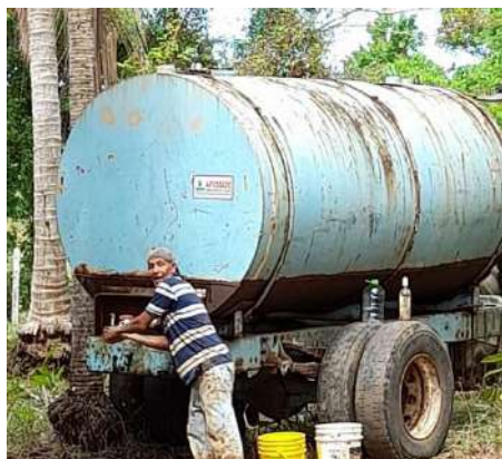
Imagen 26: Cisterna utilizada para humedecer la tierra. [Realizado por autor]
