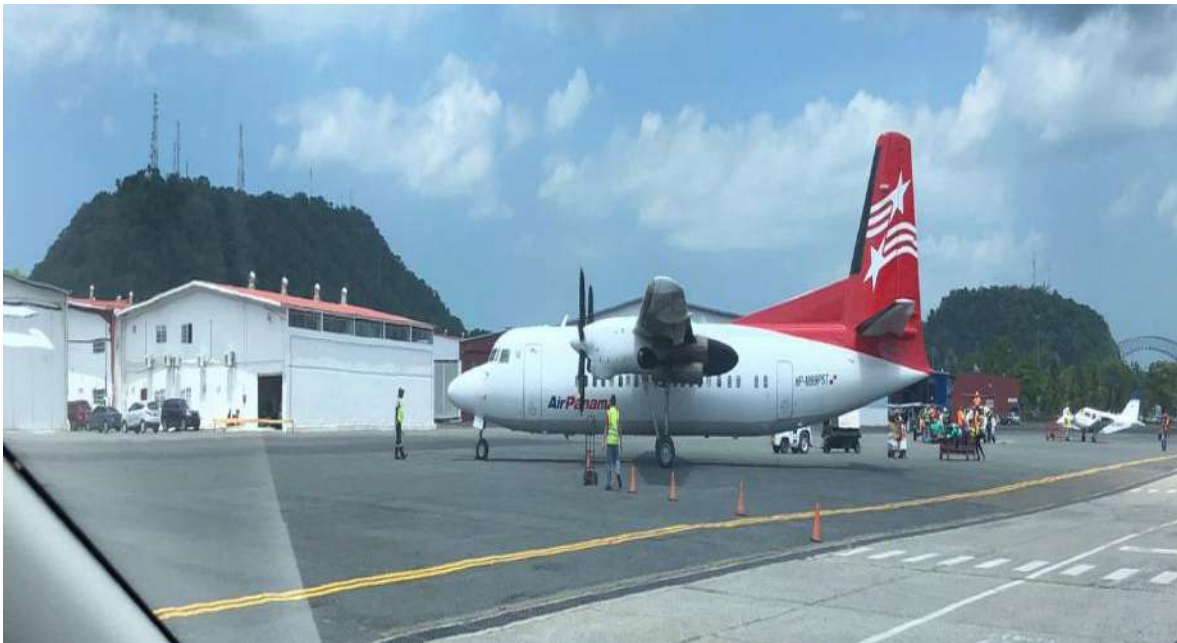
Imagen 23. Elaboración propia aeropuerto Marcos A Gelabert. Aeronave FOKER 50 – AIR PANAMA turbopropulsores Pratt & Whitney Canadá PW125B o PW127B - 2024
