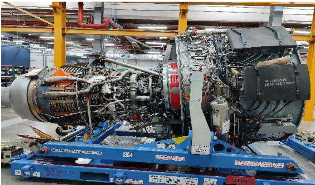
Imagen 45. Elaboración propia motor CFM internacional LEAP-1B. Masa máxima de despegue 159 400 lb (72 303 kg), capacidad de carga 966 ft 3 (27.3 m 3 ), alcance a plena carga 3800 nmi (7038 km) 3215nmi (5960 km). Aerolínea Copa Airlines, Panamá, Tocumen, hangar Copa Airlines - 2024
