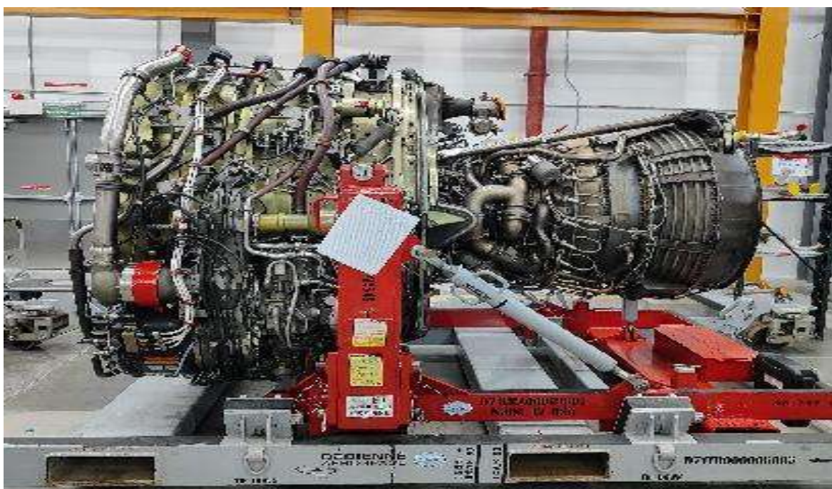
Imagen 47. Elaboración propia motor CFM internacional LEAP-1B. Masa máxima de despegue 159 400 lb (72 303 kg), Capacidad de carga 966 ft 3 (27.3 m 3 ), alcance a plena carga 3800 nmi (7038 km) 3215nmi (5960 km). Aerolínea Copa Airlines, Panamá, Tocumen, hangar Copa Airlines - 2024
