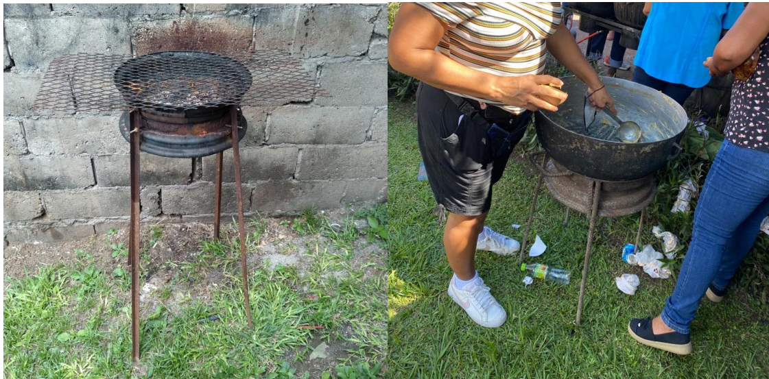
Figuras 11 y 12: Asador confeccionado con la base del rin de una llanta con estructura de parrilla removible para uso como fogón de carbón.
