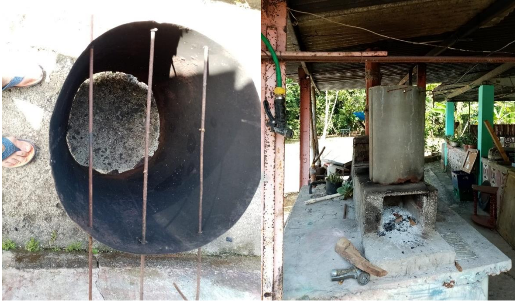
Figura 9 y 10: Ahumador de zinc y varillas, estructura y demostración de uso.
