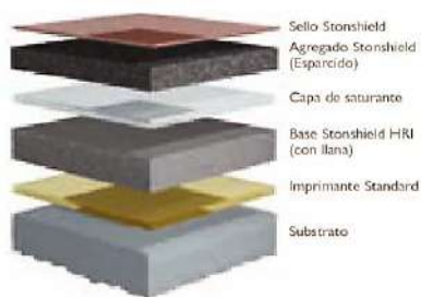
Imagen 76. Sistema de piso Stonhard, tipo Stonshield para interior y exterior del mercado. Fuente: www.Stonhard.com
