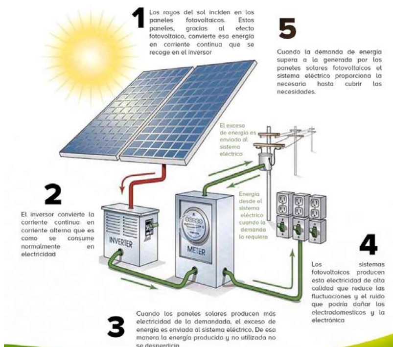
Imagen 86. Funcionamiento del sistema de paneles solares en el proyecto. Fuente: www.lansolar.com
