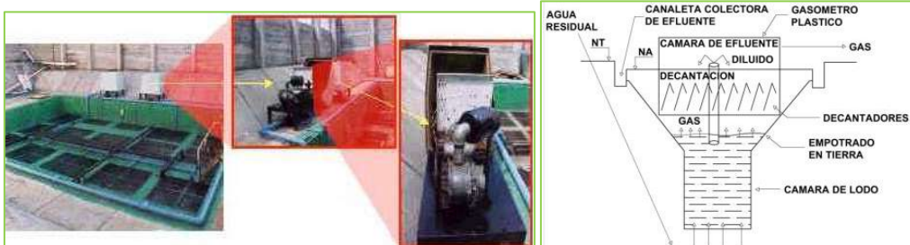
Imagen 87. Sección explicativa del sistema. Fuente: somosadvance.com
