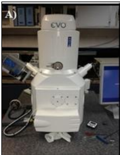
Figura 3.2 Microscopio electrónico de barrido, marca ZEISS EVO 40 VP
