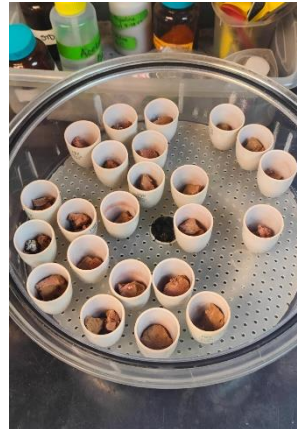
Figura 10. Muestras de suelo después de 1h a 550 °C en un deshumidificador.
