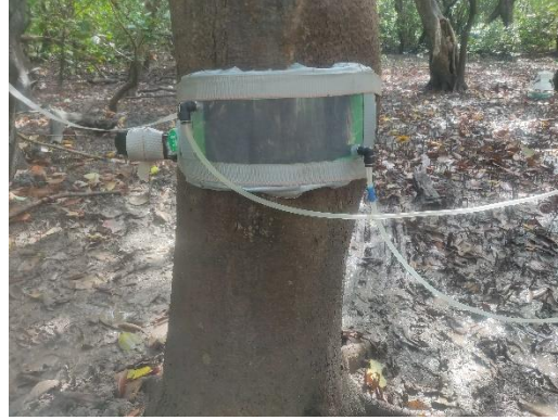
Figura 21. Cámara para la medición de gases en árboles.
