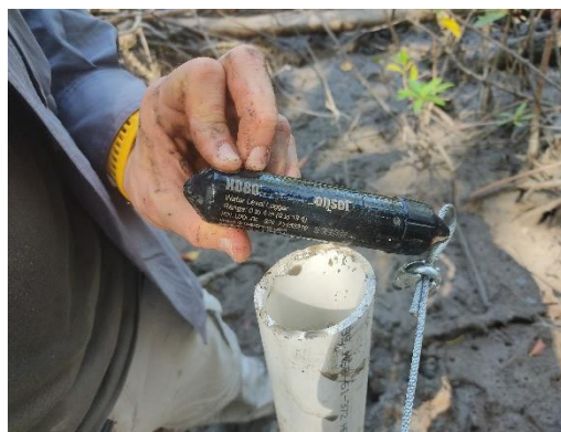
Figura 17. Retiro del registrador de nivel de agua HOBO U20L-0x.
