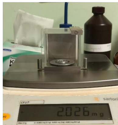
Figura 6. Pesaje de muestra de neumatóforo para determinar la cantidad de isótopos de carbono.
