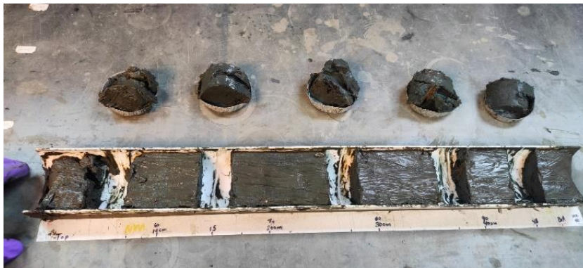
Figura 7. Muestras de los primeros 50 cm de profundidad del suelo de manglar. Se tomó una muestra cada 10 cm.
