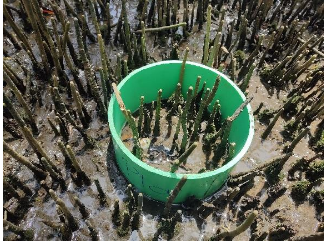
Figura 19. Anillo de PVC para la medición de gases en suelo. En el interior y exterior del anillo se encuentran neumatóforos.
