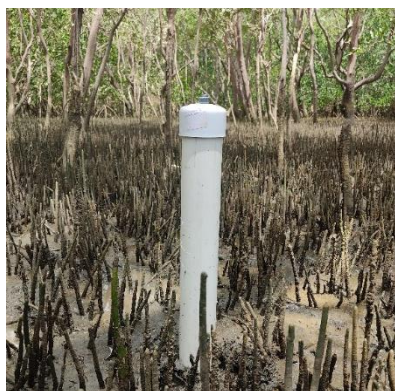
Figura 16. Instalación de tubo de PVC para el registro del nivel de agua.
