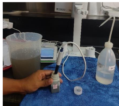
Figura 15. Medición de pH a la muestra de suelo.
