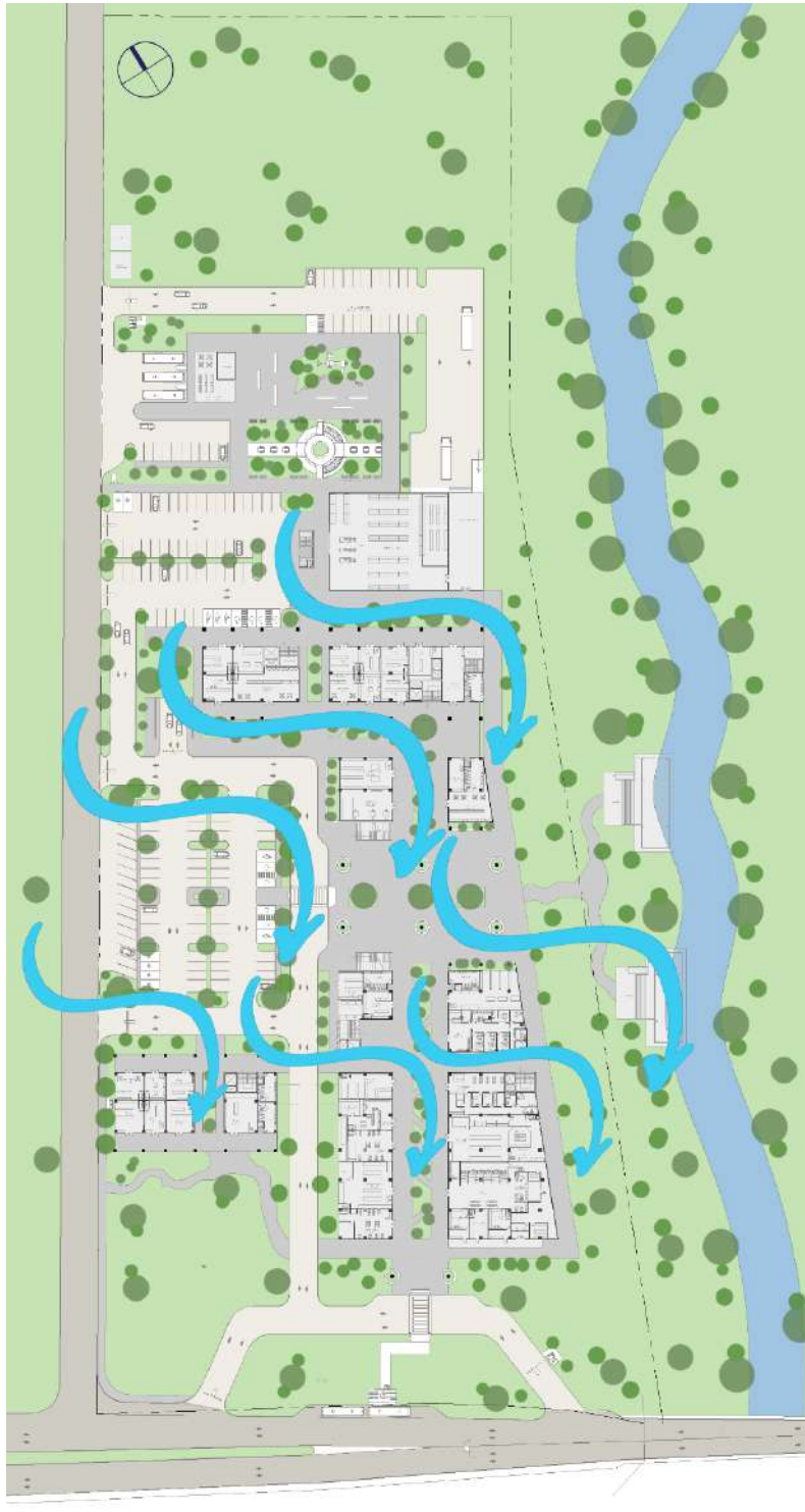
Figura 38 Ventilación cruzada en el proyecto
