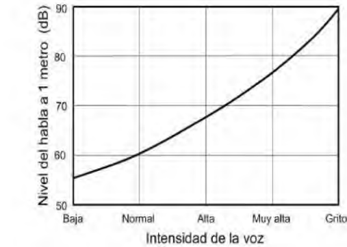
Gráfico 1.4. Niveles de SPL a 1 m, producidos por una persona con diferentes intensidades de voz. Fuente: Carrión, A.(1998).
