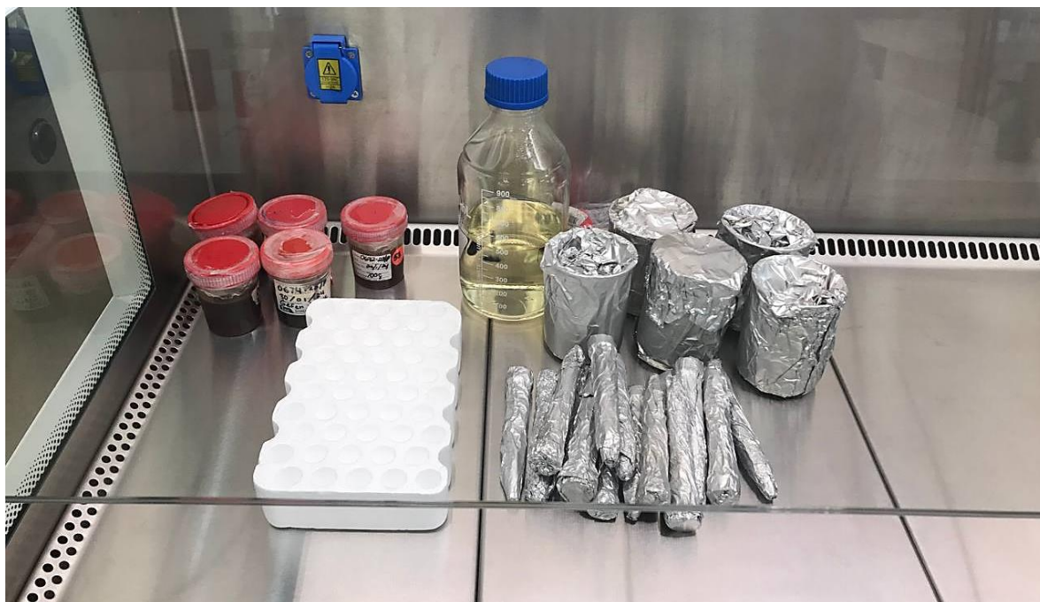
Anexo 11. Material estéril utilizado para el procesamiento de miel: envases con muestra de miel (tapa roja) y agua peptonada (botella autoclavable con tapa azul), vasos de precipitado y tubos cónicos (estériles envueltos en aluminio) dentro de la cabina de bioseguridad (BioSafety Cabinet Telstar Bio II Advance).
