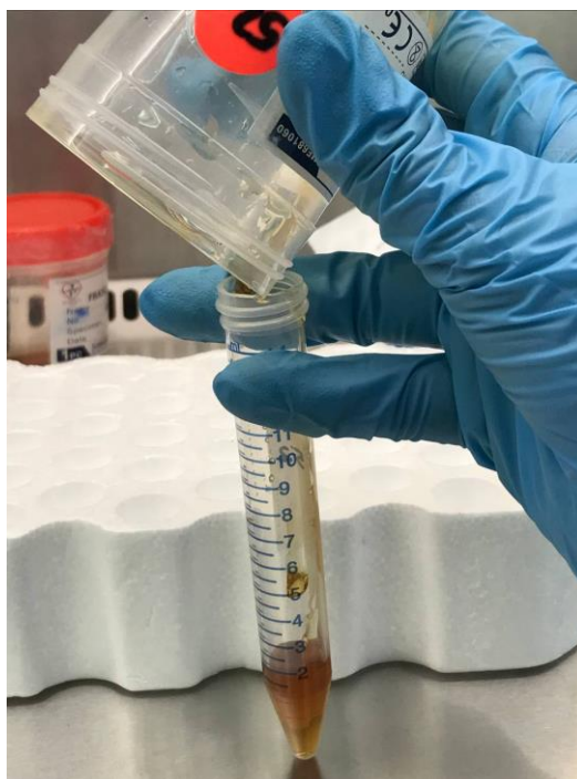
Anexo 2. A. Representación de muestras de miel en envases con tapa roja. B. Representación de método de medición de la miel mediante vertido de 10 mL de muestra en tubo cónico, para su posterior dilución.
