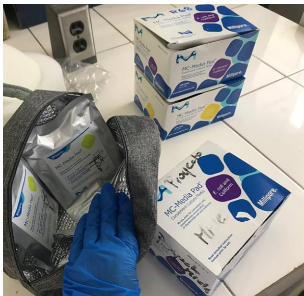
Anexo 1. MC-Media para recuento rápido de aerobios mesófilos (R-AC), coliformes totales y Escherichia coli (EC), (Merck Millipore).
