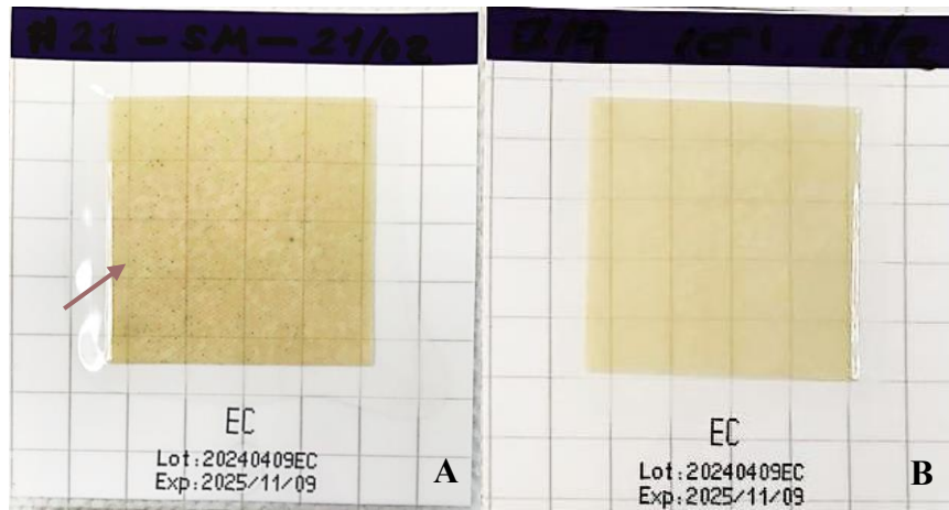
Figura 5. Representación de resultado en almohadilla A. Positivo para la presencia de coliformes totales: Solución Madre (SM) de la muestra No. 21. La flecha señala las colonias color celeste, indicando la presencia de bacterias coliformes. B. Negativo para la presencia de coliformes totales y E. coli : Dilución 10^{-1} de la muestra No.19.
