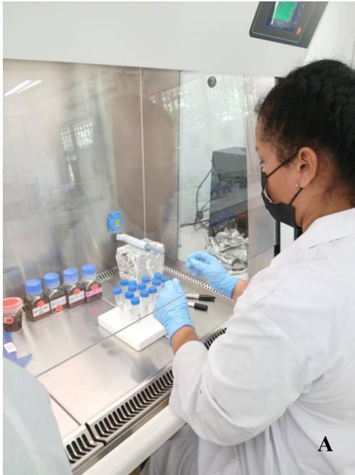
Anexo 3. A. Preparación de diluciones seriadas, al fondo de la cámara se observan las muestras (frascos con tapa azul). B. Vertido de Agar Salmonella-Shigella en platos Petri estériles desechables.
